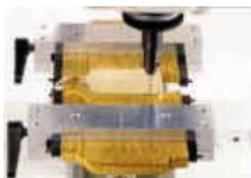
Слика 71 Гравирање со дијамантски алат со и без ротација
