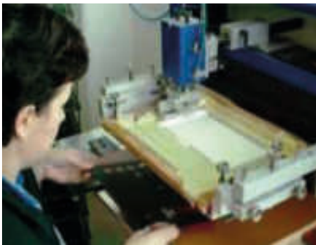
Слика 66 Сито печат на метал
