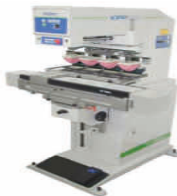
Слика 55 Отворен систем со пневматски шатл
