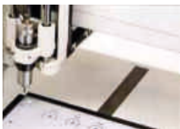
Слика 70 Гравирање со високофреквентна глава
